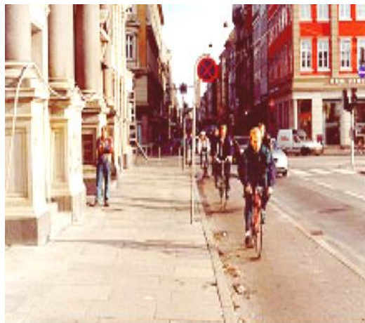
Εικόνα 6: Συνοδευτικός ποδηλατόδρομος σε διαφορετική στάθμη και διαχωριστικά στοιχεία από τις λωρίδες κίνησης των οχημάτων.
