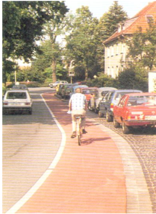
Εικόνα 2: Λωρίδα ποδηλάτου δίπλα σε λωρίδα στάθμευσης.
